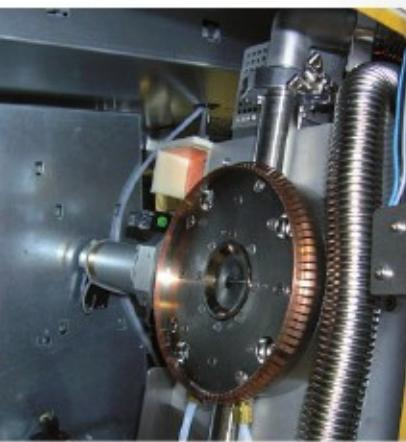
Самплер вызывает сверхзвуковое расширение плазменного газа в вакуумной области интерфейса. Температура и давление газа при этом резко падают, что обеспечивает процесс транспортировки ионов в область высокого вакуума без столкновений. Вакуумная область интерфейса ограничивается скиммером, который отсекает поток внешнего газа, пропуская ионы в область высокого вакуума.
