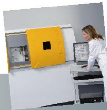
Спектрометр SPECTRO MS разработан по схеме Маттауха - Герцога (Mattauch-Herzog), масс-спектрометра с двойной фокусировкой секторным магнитным полем. Он состоит из входной щели, электростатического анализатора (ESA), энергетической щели и секторного магнита, по краю которого смонтирован планарный детектор.
