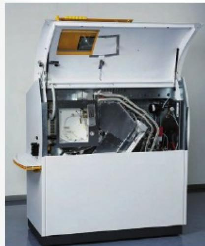
Система охлаждения ВЧ-генератора SPECTRO MS основана на воздушном охлаждении, в то время как вакуумный интерфейс требует более интенсивного водяного охлаждения. Для этих целей обеспечивается подключение внешней системы охлаждения или теплообменника.
