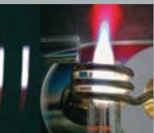
Генератор SPECTROBLUE обеспечивает мощность, стабильность и проверенную временем аналитическую производительность. Надёжность работы обеспечивается, прежде всего, за счет полупроводникового источника питания 4,5 кВ и генератора с самовозбуждением на частоте 27 МГц - оба являются лучшими в линейке моделей.
