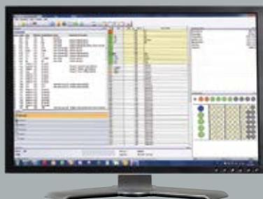
Инструкции программы разделены по категориям и связаны через центральную панель навигации. В каждой категории отображаются только соответствующие кнопки и возможности выбора. Содержание на мониторе ясно и интуитивно понятно. Переключение между категориями требует только одного щелчка мыши. Таким образом, управление этим сложным ICP-OES спектрометром остаётся очень простым.
