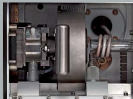
В отличие от обычных систем с двойным обзором, простой и компактный интерфейс SPECTROBLUE TI обеспечивает минимум оптических поверхностей и максимум светопропускания. Перископ из трёх зеркал расположен под горелкой и обеспечивает отражение лучей под углом 45°. Вместе с уникальным защитным окном горелки эта конструкция уменьшает загрязнения и не требует частого обслуживания. Фактически, вся линейка спектрометров SPECTROBLUE разработана с учётом минимизации настроек и обслуживания любого рода.
